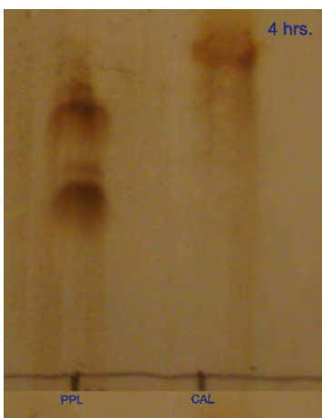
Figura 33. Placa del monitoreo a las 4 horas en que se llevo a cabo el consumo de la mezcla del monómero 1 y 2 por las enzimas ,PPL y CAL.
