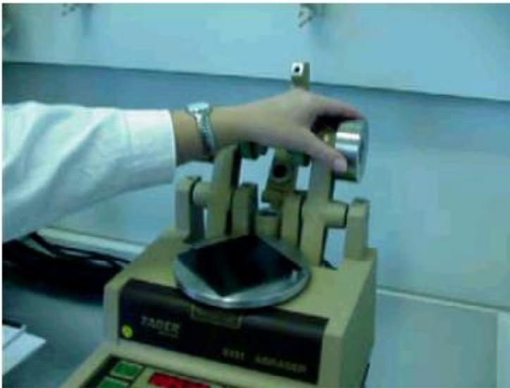
**Figura 12.** Equipo taber, mide resistencia al desgaste. (18)
