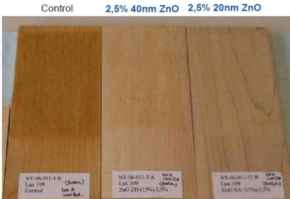
**Figura 31.** Partícula de Nano-ZnO para protección UV. Revestimiento acuoso LUX 399 curado UV. Prueba de exposición 750 h QUV-B. (18)
