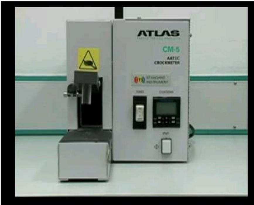
**Figura 10.** Equipo crockmeter, mide resistencia a frote y rayado. (18)
