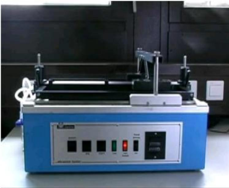
**Figura 11.** Equipo dry scrub test, mide resistencia a frote y rayado. (18)
