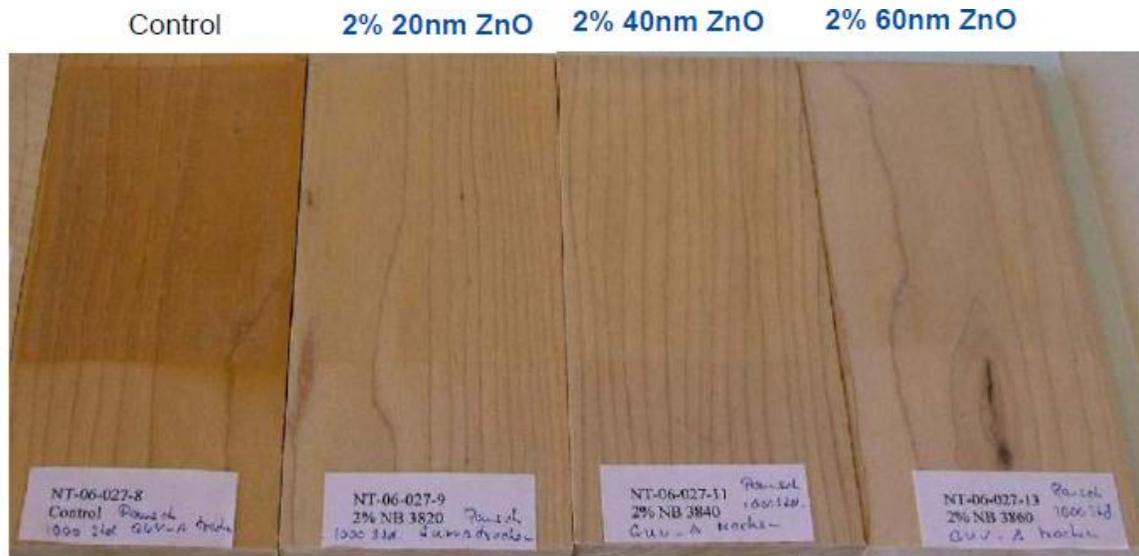
**Figura 29.** Partícula de Nano-ZnO para protección UV .Revestimiento acuoso de película delgada (120  $\mu\text{m}$ ) .Prueba de exposición 1000 h QUV-A. Barniz para muebles y pisos de madera. (18)
