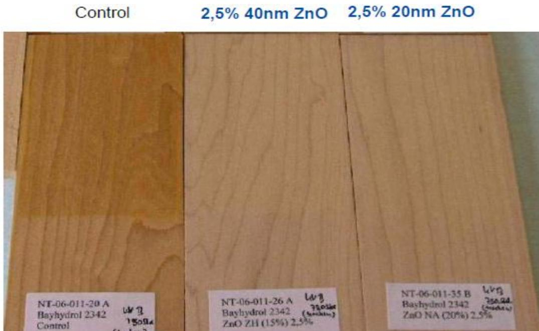
**Figura 30.** Partícula de Nano-ZnO para protección UV. Revestimiento acuoso Bayhydrol 2342 Aliphatic. Prueba de exposición 750 h QUV-B. (18)
