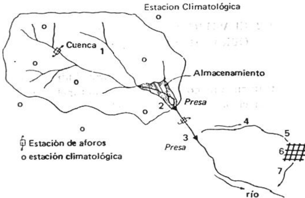
Figura 2 Aprovechamiento hidráulico, Referencia 6
