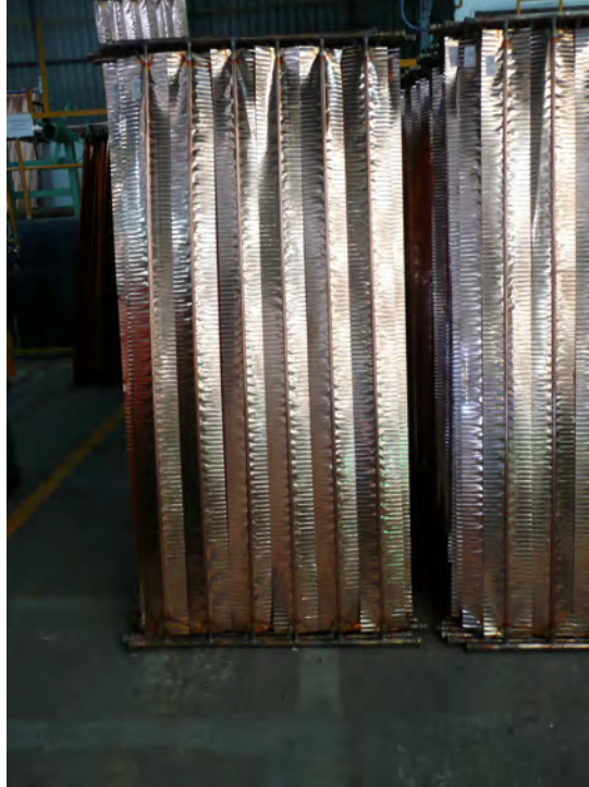
Ilustración 7: Absorbedor montado previo al proceso de pintado
