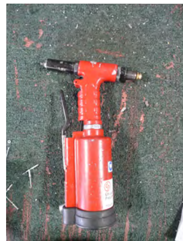
Ilustración 10: Remachadora neumática empleada en los procesos de cierre final
