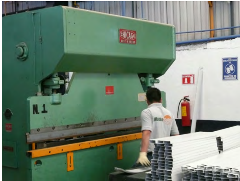
Ilustración 8: Dobladora empleada para habilitar la lámina pinto utilizada en la caja del calentador
