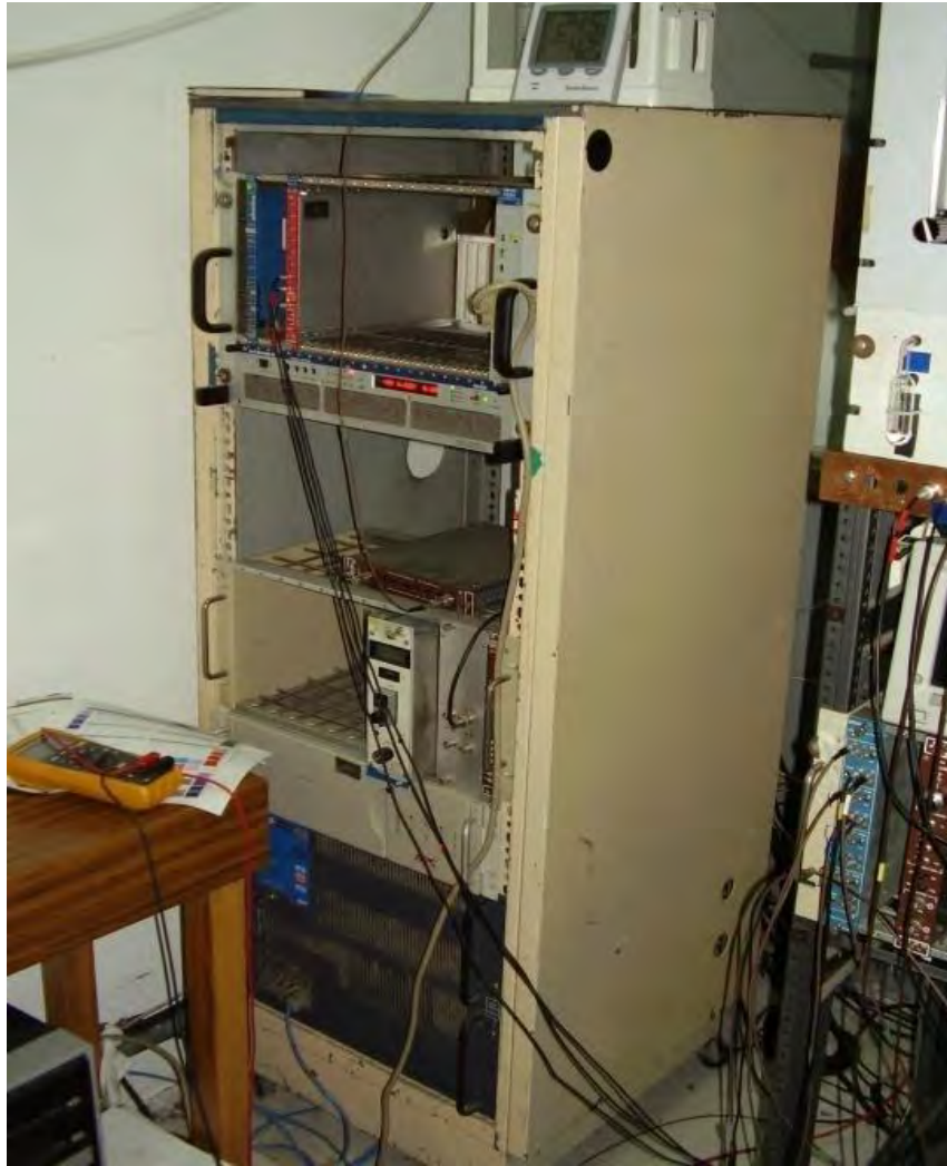
Fig.4.10 El Rack con la electrónica CAMAC en la parte superior, en medio se observa la fuente de los pre-amplificadores, abajo se ubica la fuente de alto voltaje para los centelladores y MWPC.
