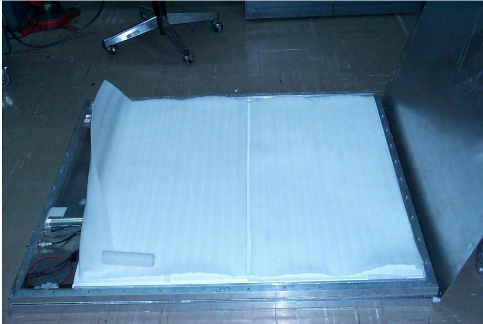
Fig. 4.2 Plástico centellador envuelto en papel Tyvek®, PMT y soportes de acrílico ensamblados dentro del armazón de aluminio.
