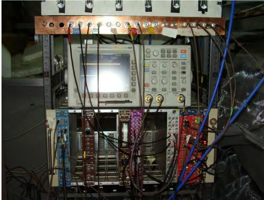
Fig.4.6 Panel de conexiones y electrónica NIM.
