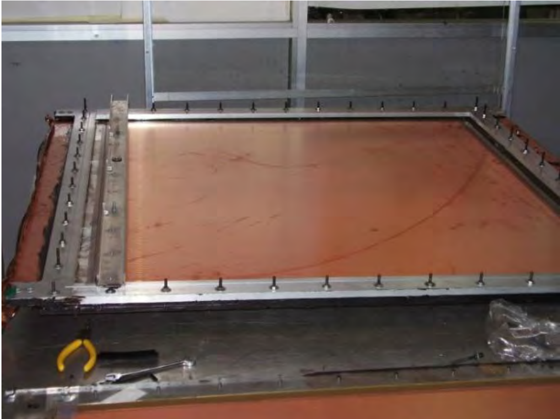
Fig.5.10 MWPC sin la tapa superior con el montaje para la caracterización de los planos. Se observa la barra con orificios que sirvió para llenar la matriz de puntos con la que se caracterizaron los planos.
