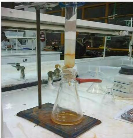
Fotografía 5. Cromatografía en columna para fraccionamiento de carotenoides
