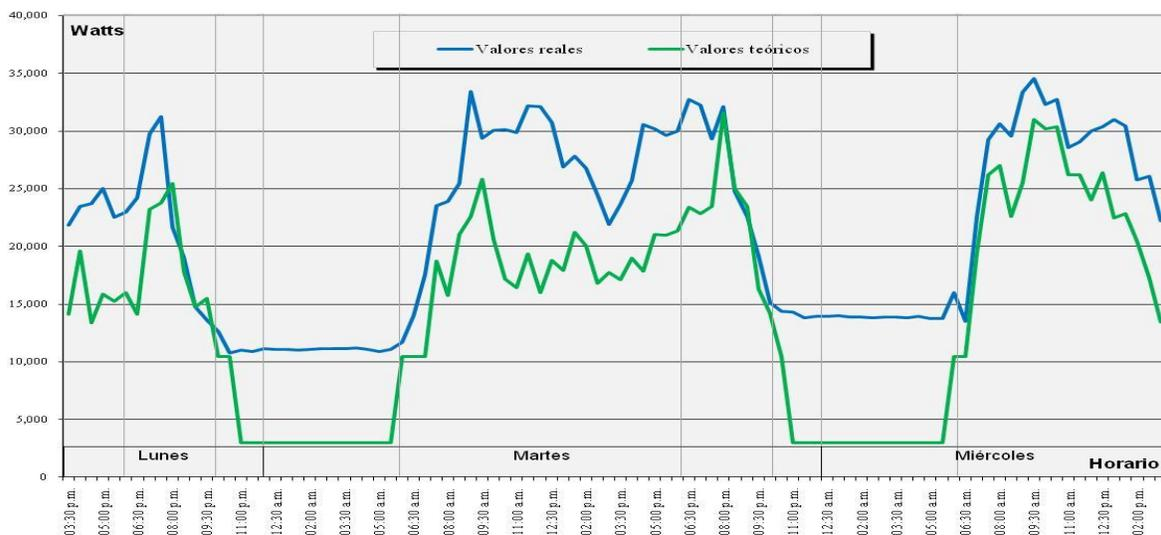
Figura 4. 4. 1a. Gráfica comparativa teórico- real del consumo en el transformador A-5.
