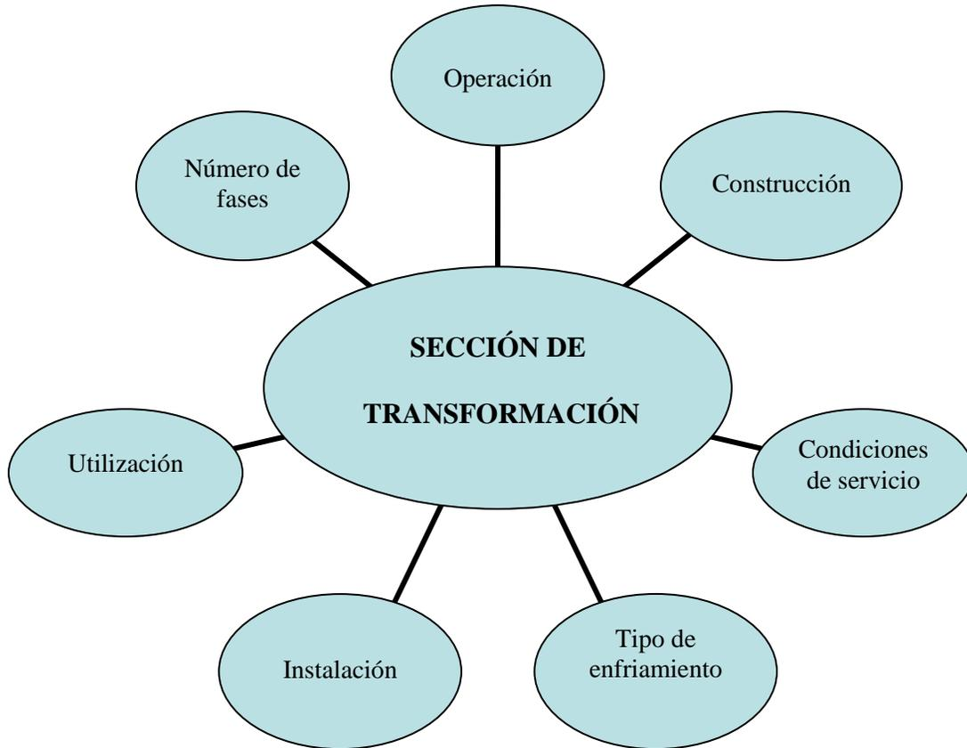
Figura 1. 5. 2a. Clasificación en la sección de transformación en una subestación eléctrica.
