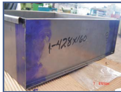
TODAS LAS LÁMINAS ESTÁN PUNTEADAS Y ASÍ QUEDÓ ARMADO.
