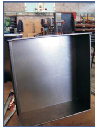
TODAS LAS LÁMINAS ESTÁN PUNTEADAS Y ASÍ QUEDÓ ARMADO.
