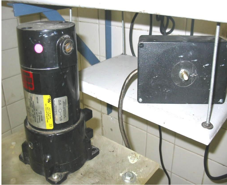
Figura 4.5. Motor eléctrico y controlador de velocidad utilizado para la agitación del digestor (dos unidades).
