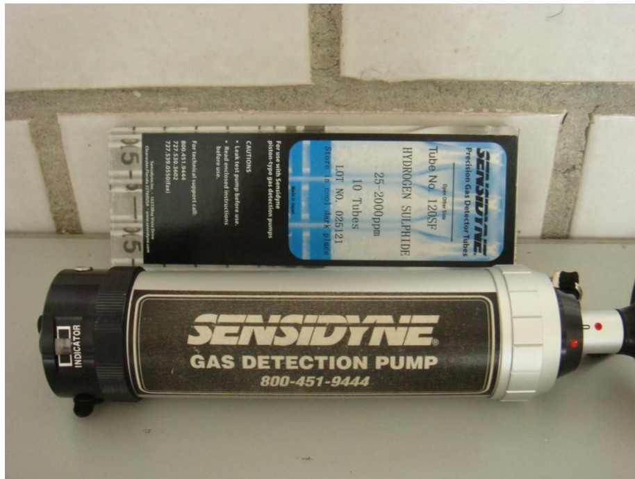
Figura 4.8. .Bomba portátil para determinar la concentración de H_2S .
