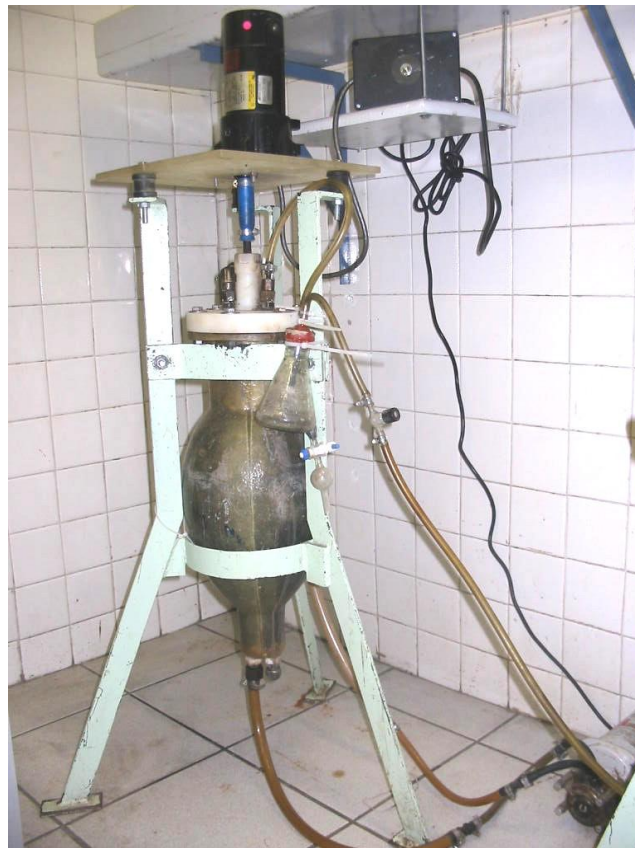
Figura 4.1 Digestor anaerobio mesofílico utilizado (dos unidades)
