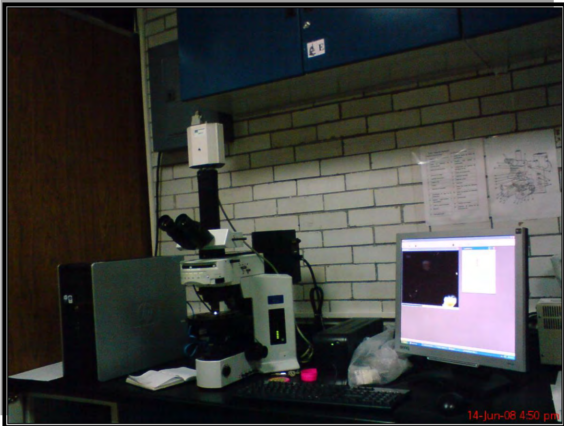
Figura 8. Microscopio que se utilizó para análisis granulométrico.
