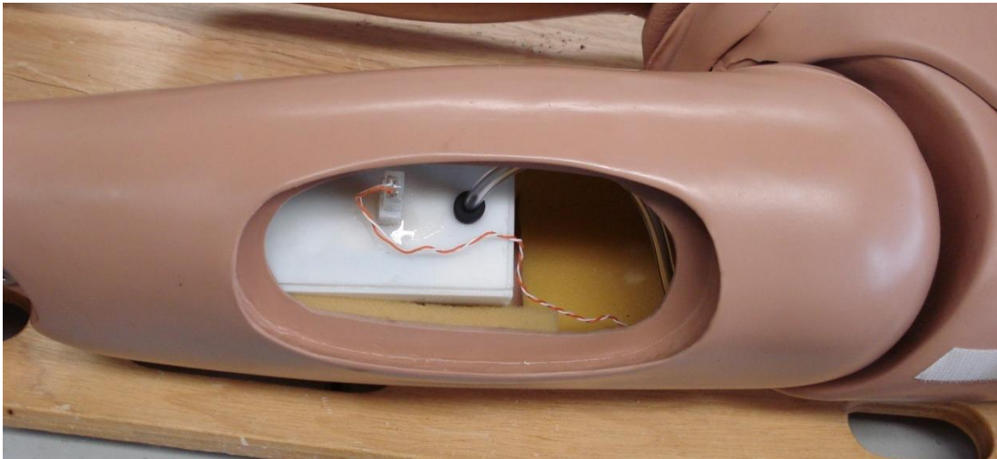
Figura 7.33. Sistema de pulso instalado.
