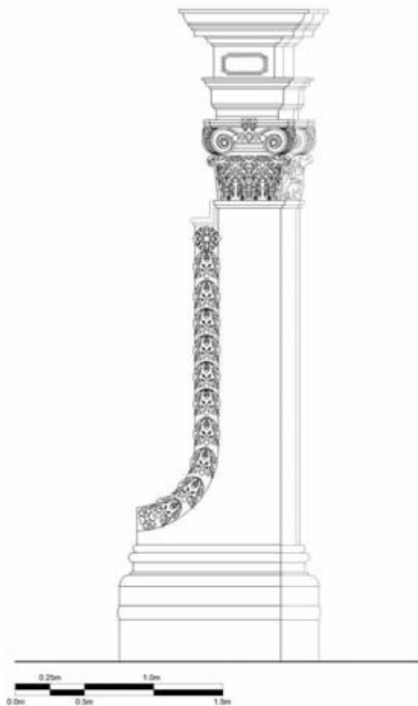
FIG:III.158 y 159. Alzados del guardacantón de la casa Mendoza. La pilastra decorada con una guirnalda de olivas que cae en curva. El capitel compuesto tiene claramente diferenciado sus dos órdenes, el corintio y el jónico.
