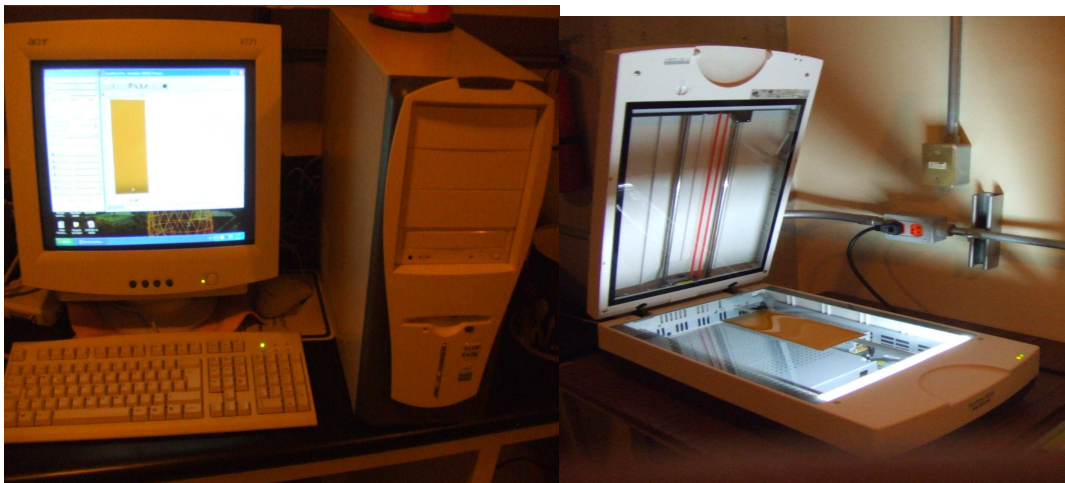
Figura 3.3 Escáner Microtek utilizado para digitalizar las películas de tinte radiocrómico.
