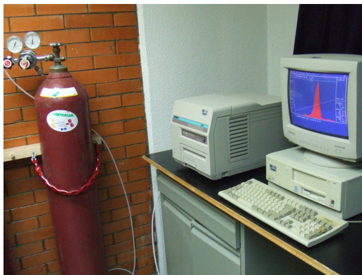
Figura 3.2 Equipo lector Harshaw modelo 3500 ICN.
