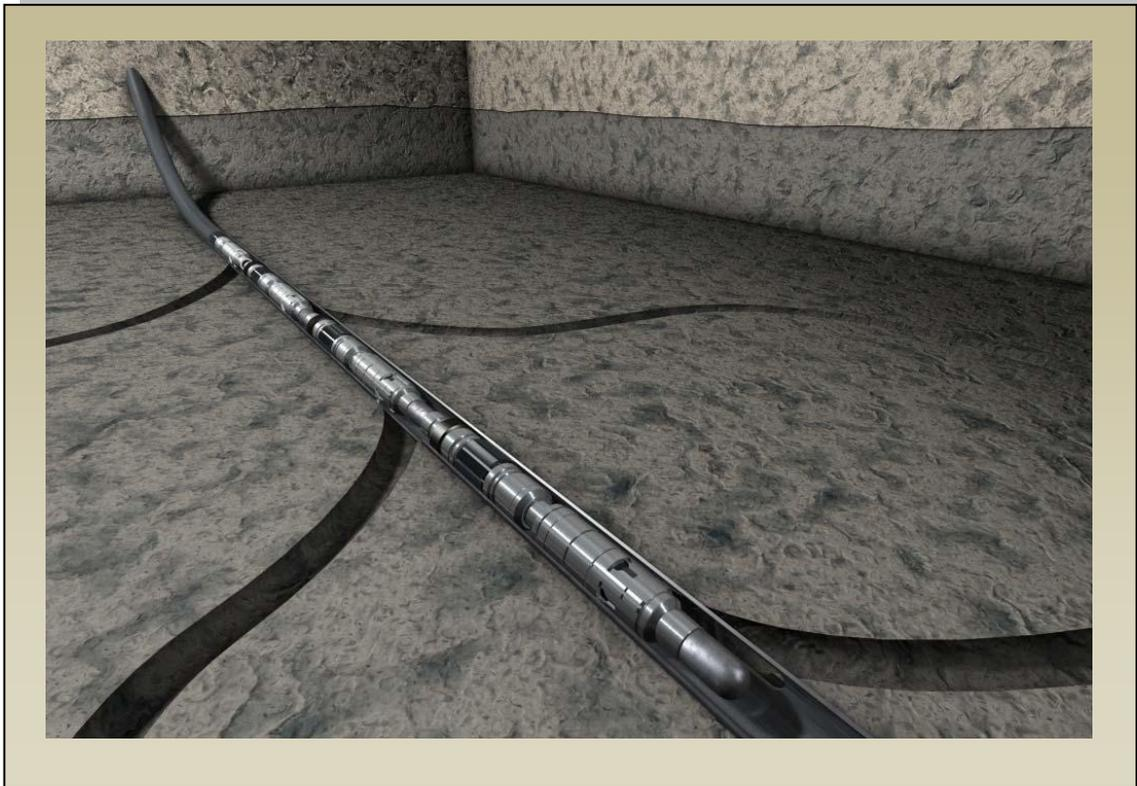
**FIG. 2E- TERMINACIÓN INTELIGENTE EN EL POZO PRINCIPAL DE UN MULTILATERAL PARA AISLAR Y CONTROLAR LA AFLUENCIA DE CADA LATERAL.**
