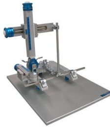
Figura 33: imagen de un aparato Estereotáxico, donde se fija la cabeza de las ratas a las cuales se les aplica algún tipo de tratamiento.
