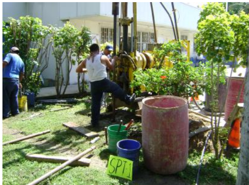
FIGURA 19.- REGISTRO DEL SONDEO SPT – 1
