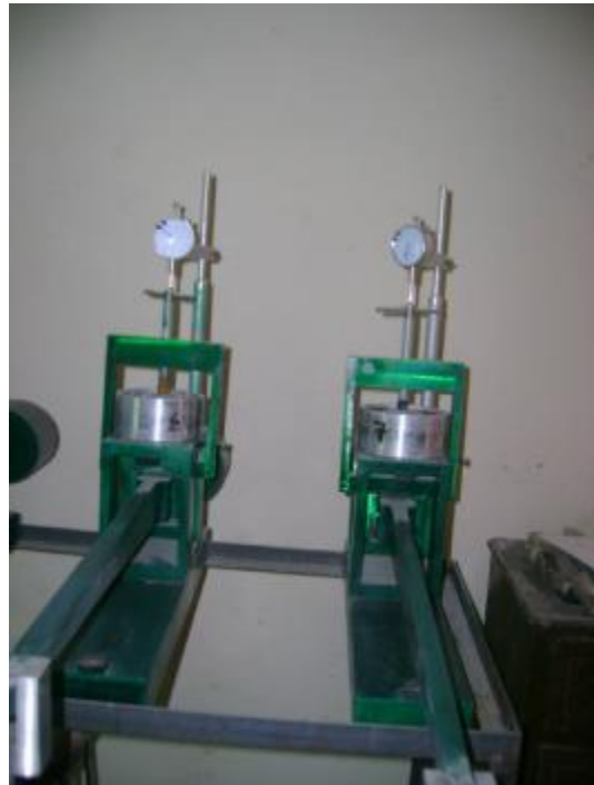
Prueba de consolidación
