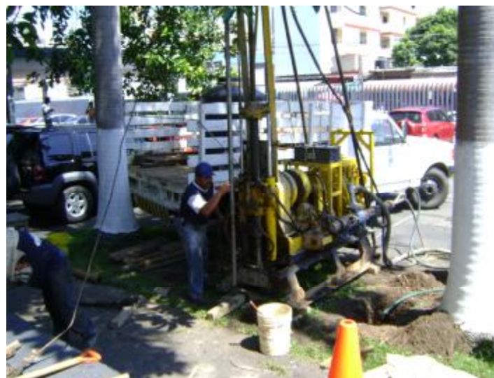
FIGURA 21.- REGISTRO DEL SONDEO SPT – 2
