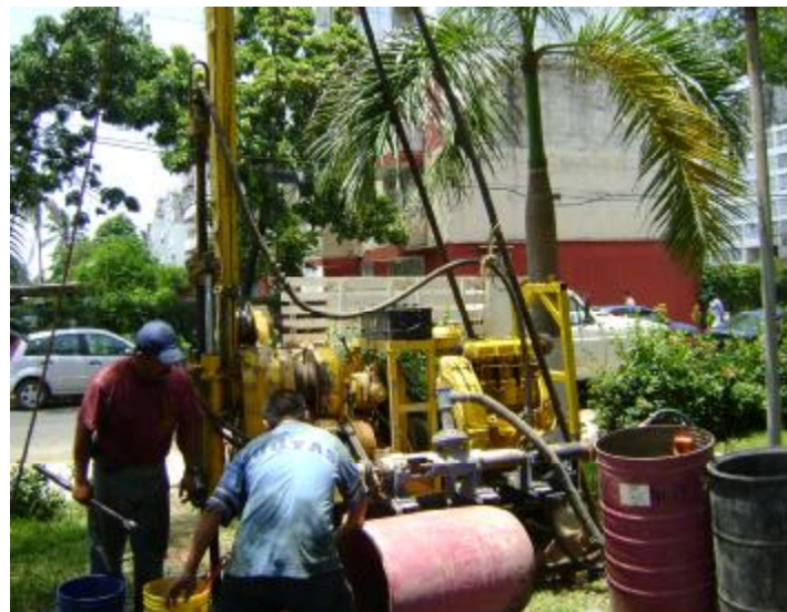
FIGURA 26.- REGISTRO DEL SONDEO SPT – 4
