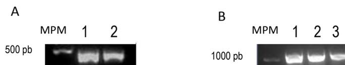
Imagen 12. Geles en los que se muestran los productos de amplificación de los promotores obtenidos de la reacción. Se observan 2 geles en los que se corrieron los productos de amplificación de cada una de las secuencias respectivamente (MPM= Marcador de Peso Molecular).
