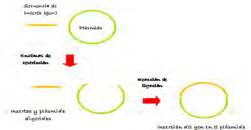
Esquema 4. Metodología para llevar a cabo para la clonación de una secuencia específica en un plásmido.
