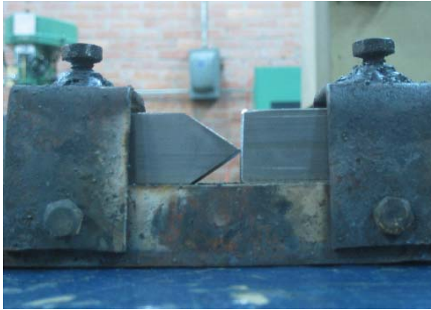
Fig. 5 - Montaje de piezas en perfil tipo K para ser unidas.
