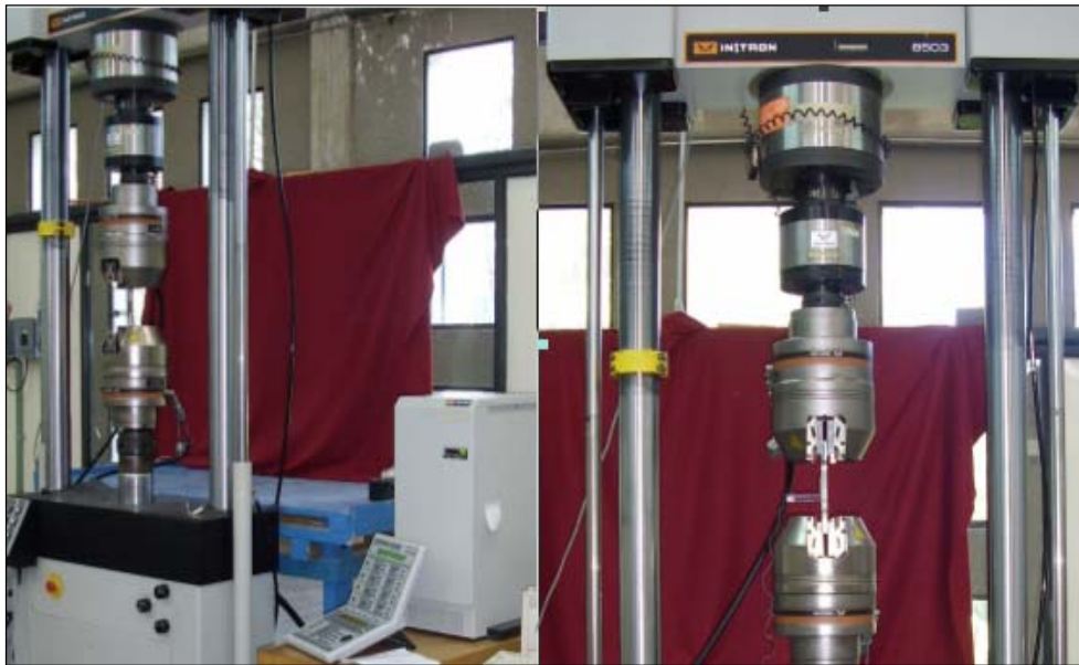
Fig. 16 Máquina de ensayos universales Instron 8503 para 100 Tons.
