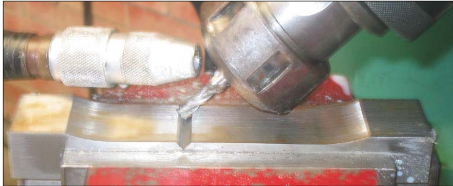
Fig. 13 – Maquinado de entalla en la ZAC.
