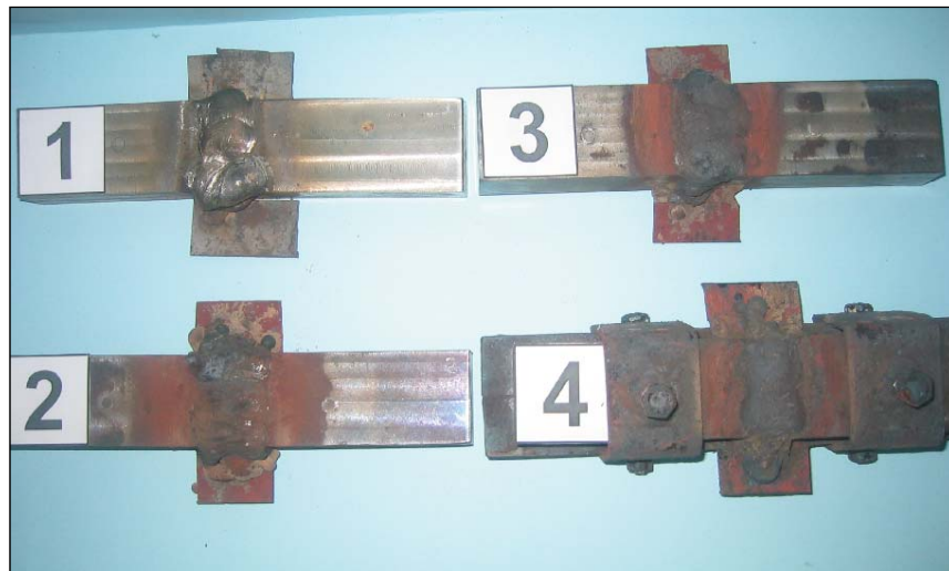
Fig. 8 – Cuatro procesos de soldadura terminados con tratamientos térmicos.
