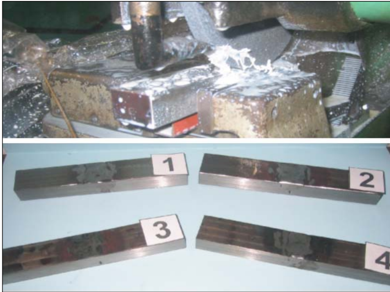
Fig. 9 – Maquinado para desbaste de exesos de soldadura.
