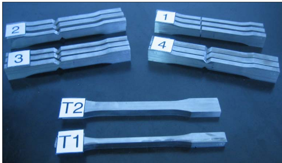
Fig.14 obtención de 3 probetas de cada proceso y 2 probetas testigos.
