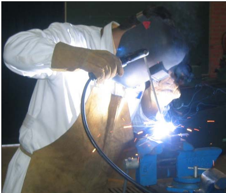
Fig. 6 – Aplicación de soldadura por arco eléctrico de c.c.
