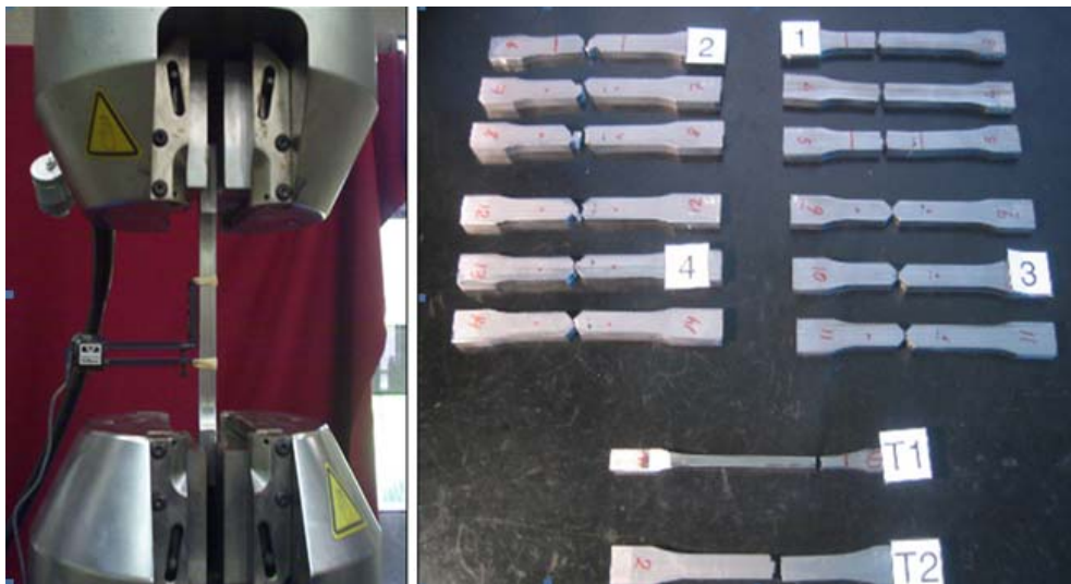
Fig. 17 Montaje de probeta en mordazas y extensómetro
