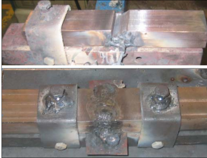
Fig. 7 – Soldadura aplicada a las piezas, listas para el tratamiento térmico
