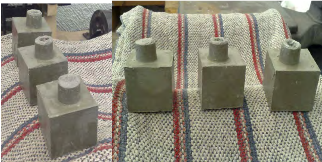
FIGURA 54 CUBOS DE MORTERO DE AZUFRE PARA ENSAYO A COMPRESIÓN
