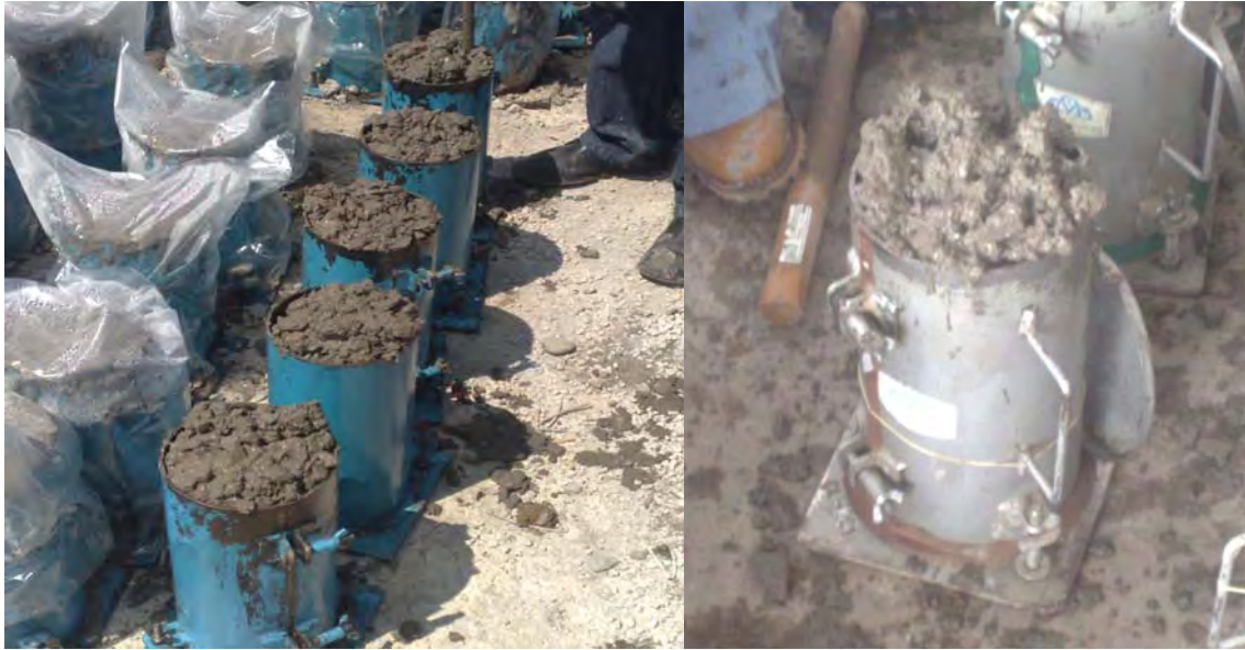
FIGURA 41 EXCEDENTE DE CONCRETO EN ESPECÍMENES CILÍNDRICOS
