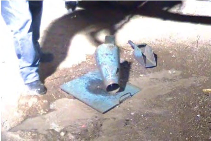
FIGURA 33 ÁREA NO NIVELADA
