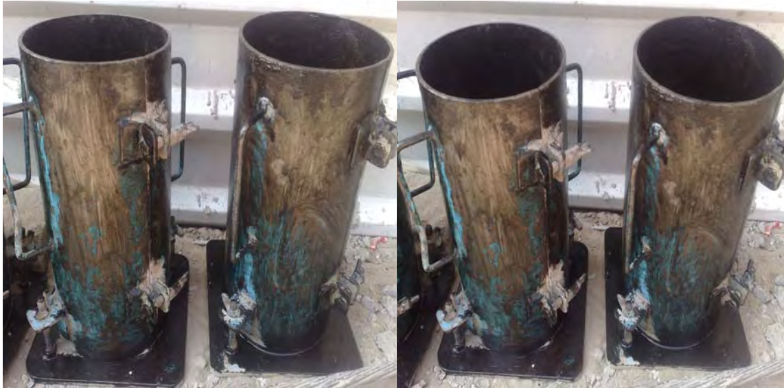
FIGURA 38 ESPECÍMENES CILÍNDRICOS REVESTIDOS CON DESMOLDANTE
