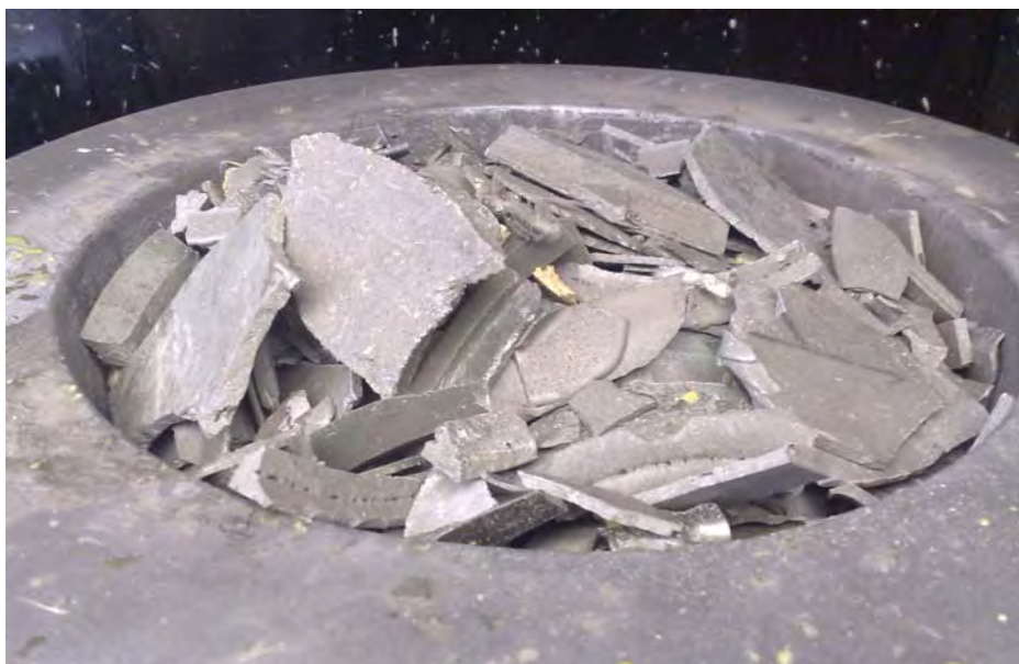
FIGURA 56 PREPARACIÓN DEL MORTERO DE AZUFRE
