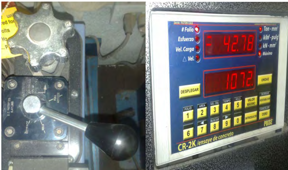
FIGURA 73 POSICIÓN No. 3 - APLICACIÓN CONSTANTE DE CARGA
