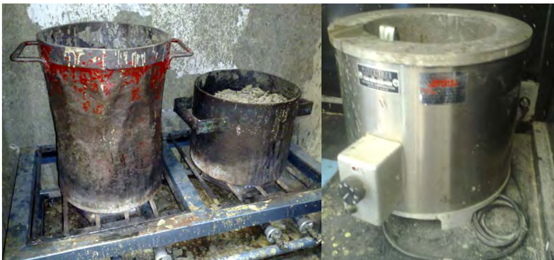
FIGURA 50 RECIPIENTES PARA FUNDIR EL MORTERO DE AZUFRE
