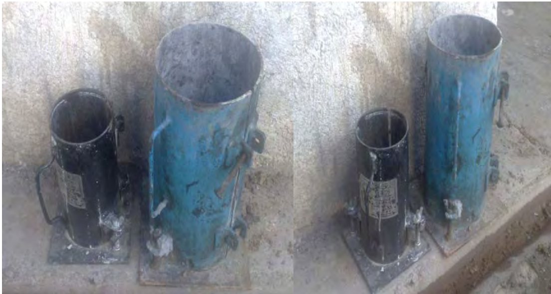
FIGURA 37 MOLDES CILÍNDRICOS QUE CUMPLEN CON LA RELACIÓN 2:1
