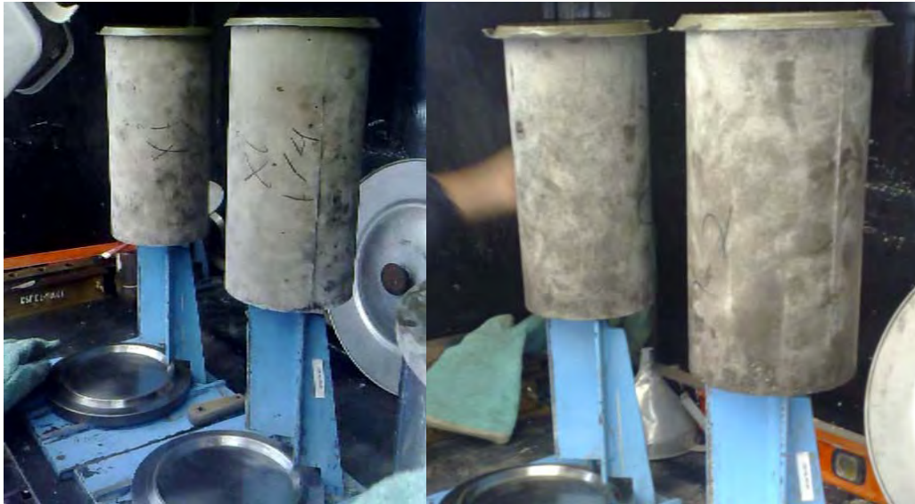
FIGURA 65 PREPARACIÓN DE CABECEO SEGUNDO EXTREMO
