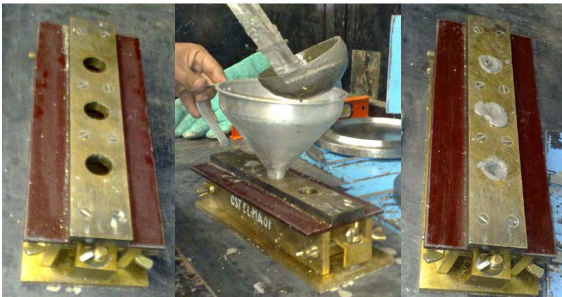
FIGURA 53 COLADO DE CUBOS DE MORTERO DE AZUFRE
