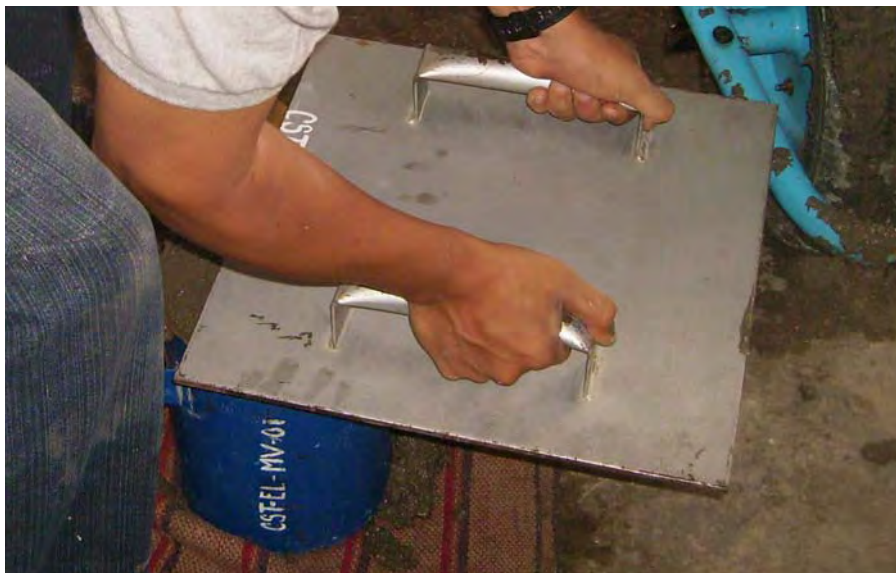
FIGURA 85 ENRASE CON PLACA METÁLICA - 2
