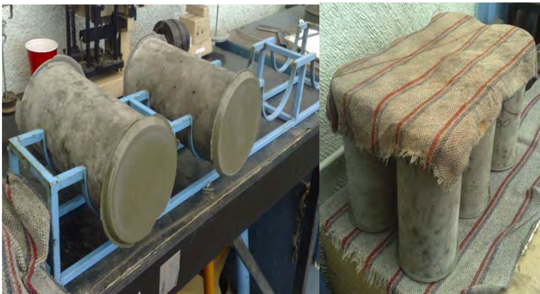
FIGURA 66 CONDICIONES DE HUMEDAD DESPUÉS DEL CABECEO
