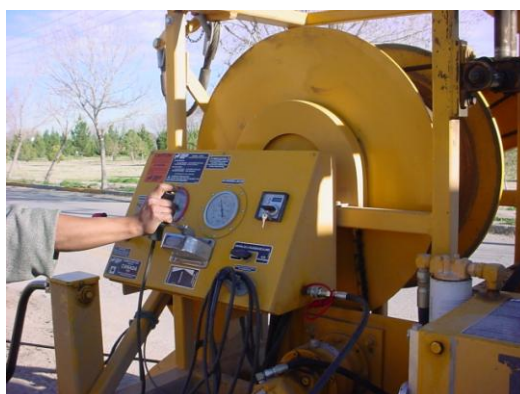
Foto 7. Tablero de control del malacate
