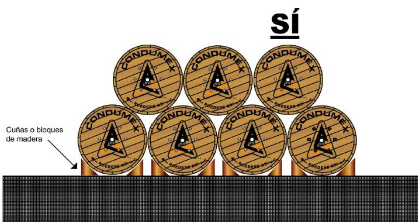
Figura 26. Almacenaje correcto de carretes con cables en capas y en posición vertical
