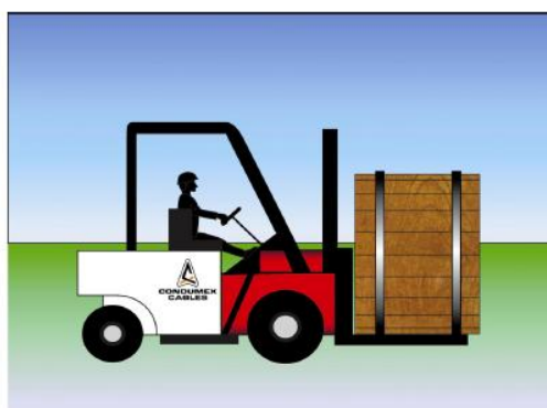
Figura 27. Manejo correcto de los carretes usando montacargas
