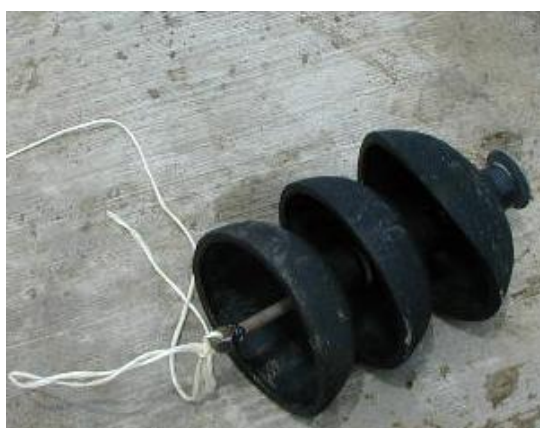
Foto 18. Guiado de ductos
