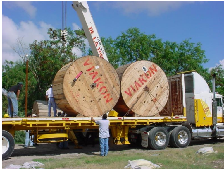
Foto 2. Posición y fijación correcta de los carretes en el medio de transporte Fuente: coemsa
