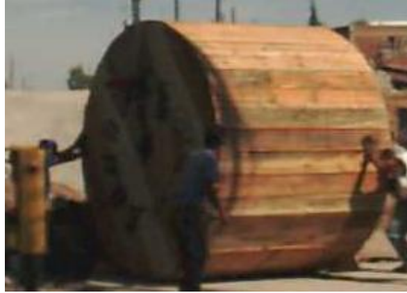
Foto 4. Aspecto del carrete con duelas de madera
