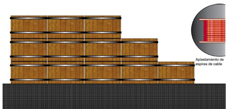
Figura 25. Almacenaje incorrecto de carretes con cables en capas y en posición horizontal
