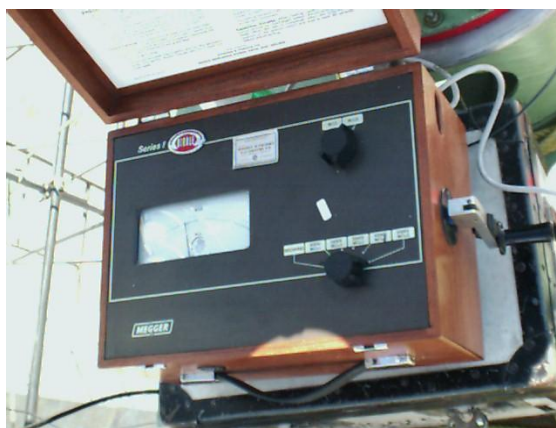
Foto 35. Megger para medir la resistencia de aislamiento
