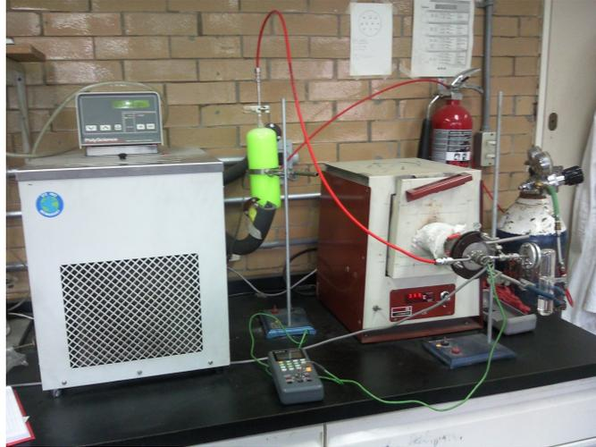
**Figura 3.10:** *Equipo de medición para el método de cuatro puntas del Laboratorio de Materiales de Alta Temperatura, FQ.*
