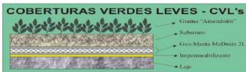
Figura 5.2.11 Diversas capas de una CVL. Vecchia, F. (2005).
