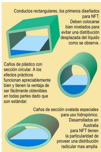
Figura 9 Tubería utilizada para hidroponía. De C. Arano, ABC de la hidroponía
