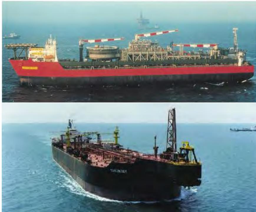
Figura 2.3 Buques usados para la extracción del petróleo: sistema FPSO en la imagen superior; sistema FSO en la imagen inferior
