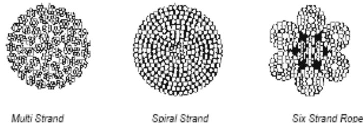
Figura 2.11 Cables de acero
