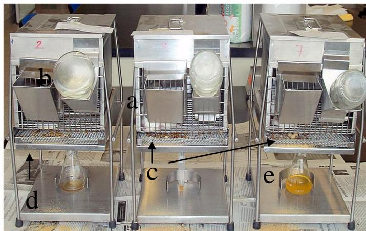
Figura 5. Cajas metabólicas. Estas cajas están diseñadas para monitorear todos los consumos y deshechos de los animales, en un periodo de 24 hrs. Cuentan con un compartimiento para el alimento
