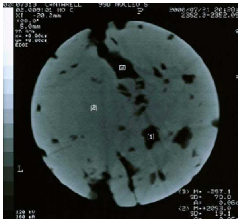
Figura 5.1 Muestra de núcleo mostrando fracturas naturales y cavidades, típico de esta formación.
