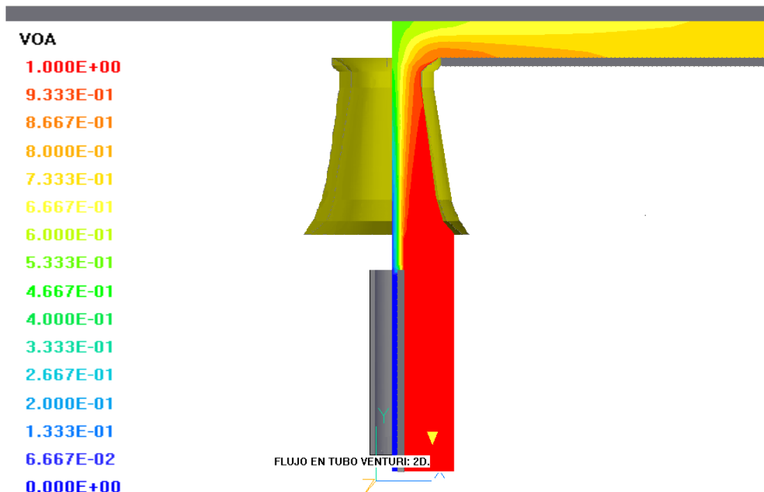
Figura 4.11 Contorno de Fracción Volumétrica del Aire en tubo de sección transversal variable
