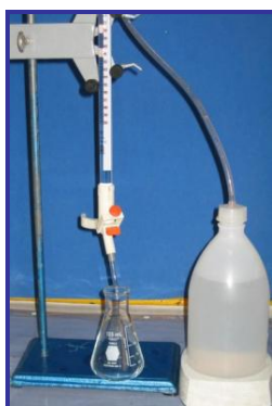
Figura 22. Determinación de acidez por método volumétrico
