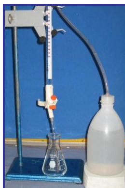
Figura 22. Determinación de vitamina C por método volumétrico
