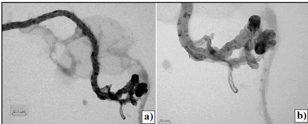
Fig. 4.16. Microscopía electrónica de transmisión (TEM): injerto por interacción no covalente entre la queratina y los nanotubos de carbono crudos MWNT's observados a a) 100,000 y b) 300,000 ampliaciones.
