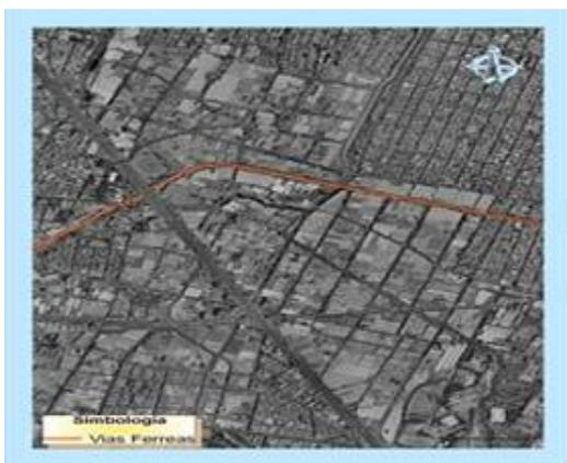
La vía de ferrocarril de Acámbaro tienen una longitud de 2100 metros, en *La Perla*, y una restricción absoluta de construcción de 20 metros a partir del eje, (40 metros total), se encuentran en desuso desde 1995 e invadidas por asentamientos irregulares, forman un efecto barrera y dividen a *La Perla*. (Imagen 4.4)
