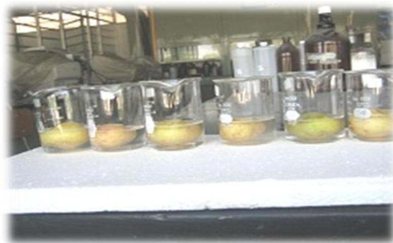
**Figura 7. Papas Cambray inmersas en soluciones con diferentes concentraciones de Yodatos.**
