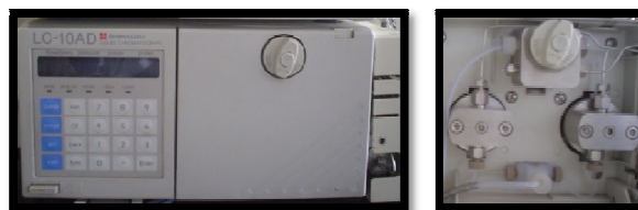
Fig. 2.9. Bomba mecánica de pistón. Módulo completo (Izquierda). Cabezales de bombas de pistones reciprocantes (Derecha).
