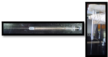
Fig. 2.11. Microjeringa, complemento del sistema de introducción de muestra.
