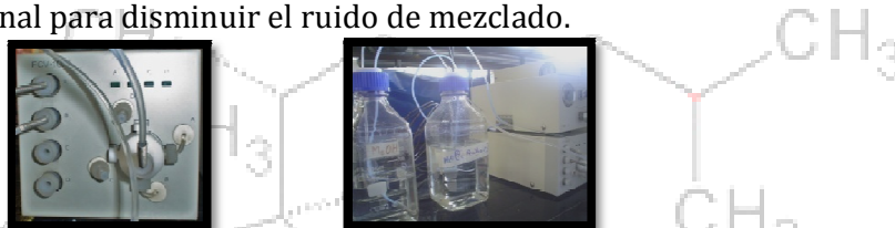
Fig. 2.10. Mezclador cuaternario de baja presión (Izquierda). Fuente de fase móvil, desgasificador y mezclador conectados (Derecha).
