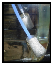
Fig. 2.7. Frasco de vidrio, fuente de fase móvil (izquierda) y filtro (derecha).
