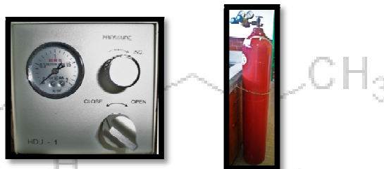
Fig. 2.8. Desgasificador de gas inerte. Izquierda, manómetro para controlar presión y caudal del gas inerte. Derecha, tanque contenedor del gas (He).
