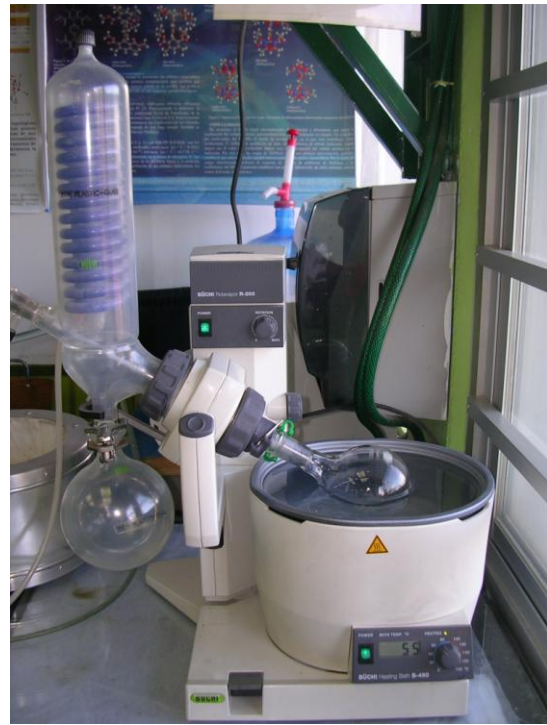
Figura 26. Separación de la mezcla ( n -hexano-grasa) en rotavapor
