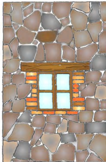
Cerramiento con dintel de madera.
