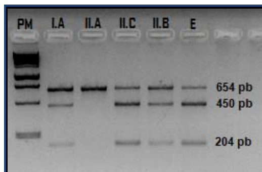
Figura 4.6. Gel de agarosa al 3% donde se muestran los RFLP's realizados con la enzima Apa I en los amplificadores de 654 pb del paciente II.C y sus familiares, además de la paciente E.
