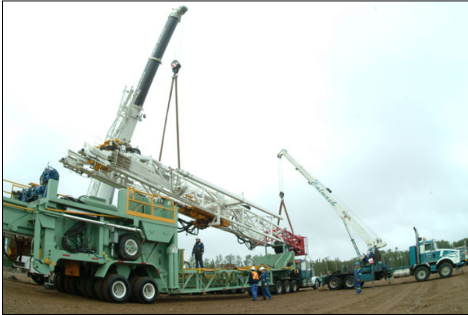
Figura.4.4. Inicio de la perforación de los pozos horizontales del SAGD en el proyecto de Long Lake [5] *
