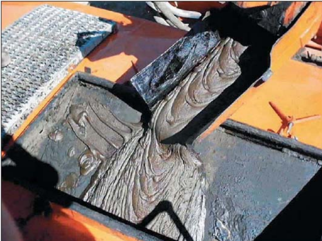
Fig. 1.2. Lechada producida por el método de producción de petróleo pesado en frío con arena (CHOPS) [1]*
