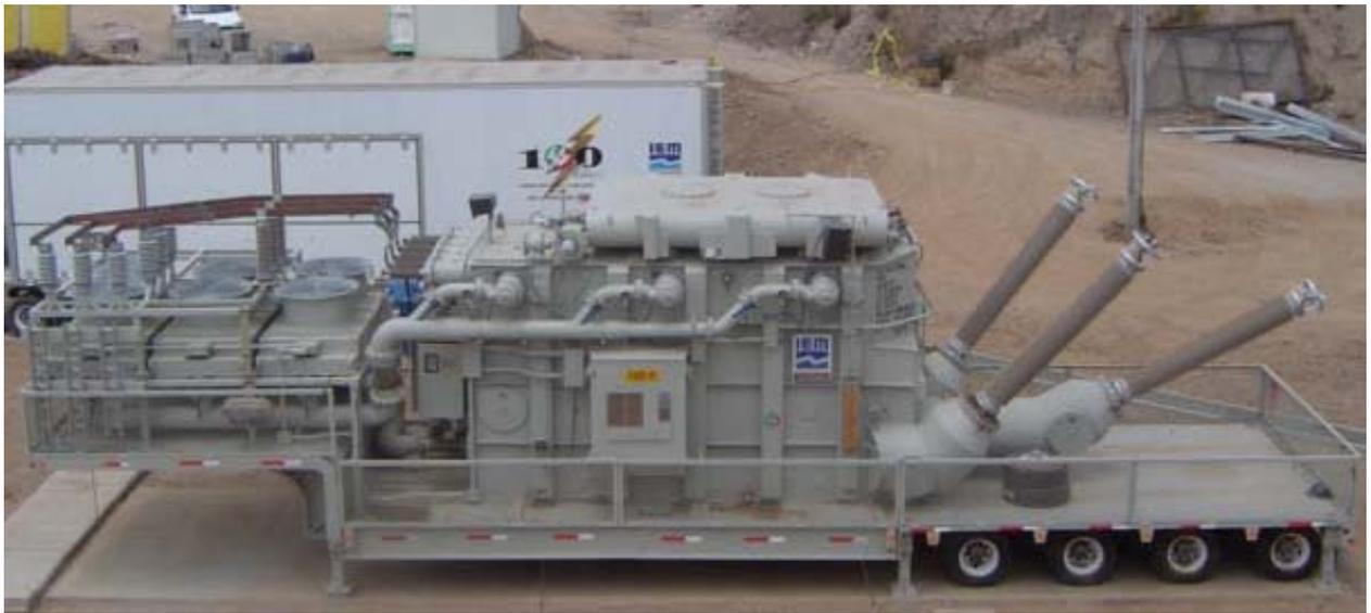
2.3.- Subestación móvil con transformador tipo columnas de 45 MVA, 230 kV,
