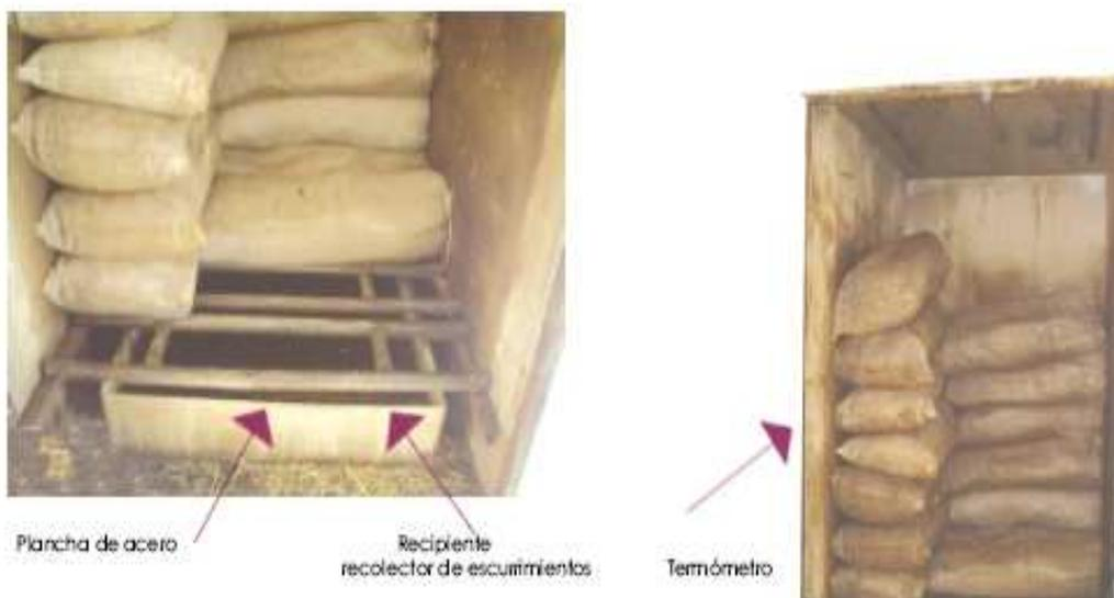
Figura 22. Almacenamiento de los costales de paja en el micro-túnel (Fernández, 2004)
