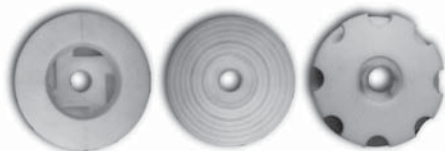
Fig. 5. Distintos tipos de rotores para el sistema de desgasificación rotor-inyector. De izquierda a derecha, rotor estándar, liso y muescado.
