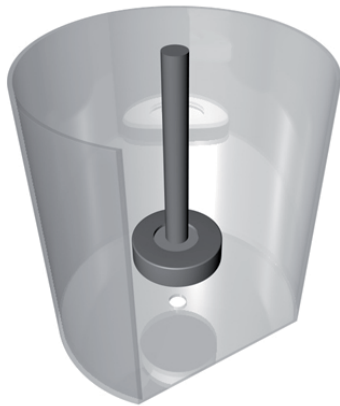
Fig. 14. Sistema final, ensamblado con el rotor liso en la punta de la flecha,
