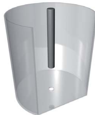
Fig. 13. Sistema utilizado para ensamblar el modelo final, se observa una flecha truncada.
