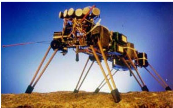
Figura 5.9. Robot Genghis, uno de los utilizados por Rodney Brooks en sus trabajos iniciales sobre arquitecturas subsumidas en el MIT. Actualmente está retirado y vive en el *Smithsonian Air and Space Museum*. <http://groups.csail.mit.edu/lbr/genghis/>.
