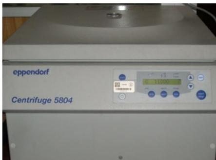
**Figura 3. 5 Centrífuga utilizada para el separado de los remanentes de urea,  $H_2O$ ,  $Cl^-$ , etc. con el catalizador.**
