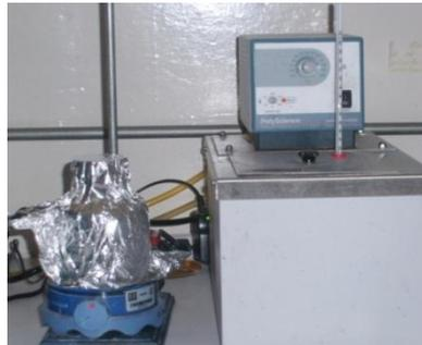
**Figura 3. 4 Reactor tipo bach de doble pared con un recirculamiento de agua a 80°C.**
