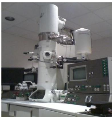
**Figura 3. 11 Microscopio Electrónico de Transmisión JEM-2010F FASTEM.**
