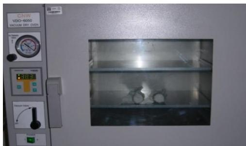
**Figura 3. 6 Estufa utilizada para el secado de los catalizadores.**
