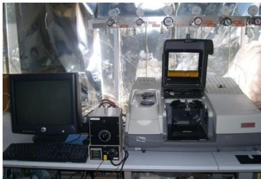
**Figura 3. 13 Espectrómetro Infrarrojo Nicolet-Nexus 670 FT-IR marca THERMO.**
