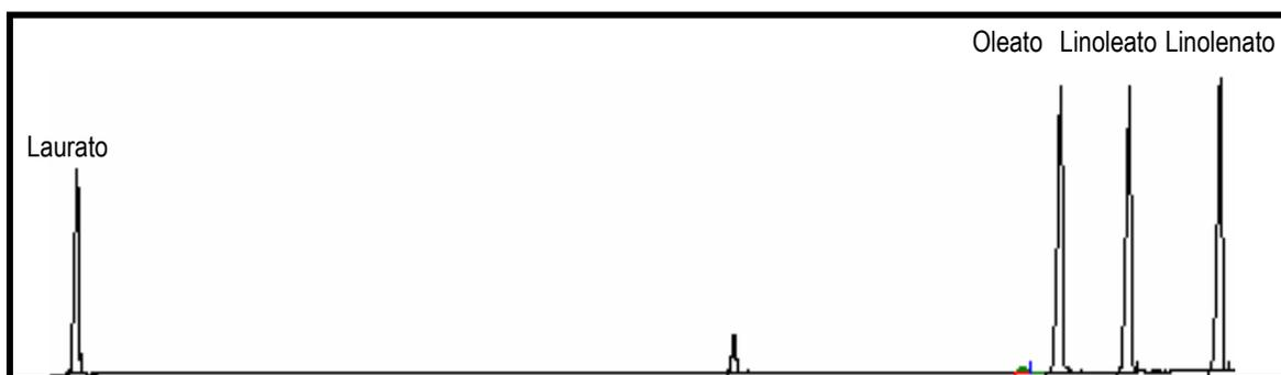
**FIGURA. 14** Cromatograma de la fortificación de oleato, linoleato y linolenato de metilo en el segundo nivel.
