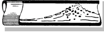
Fig. 1.5 Flujo Intermitente tipo Bache
