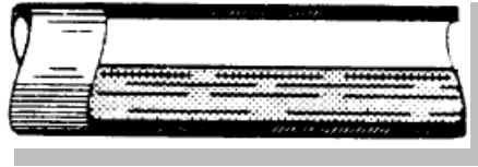
Fig 1.3 Flujo Segregado tipo Estratificado
