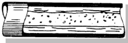
Fig 1.6 Flujo Estratificado tipo Anular
