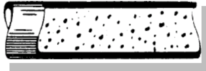
Fig. 1.7 Flujo Distribuido tipo Niebla
