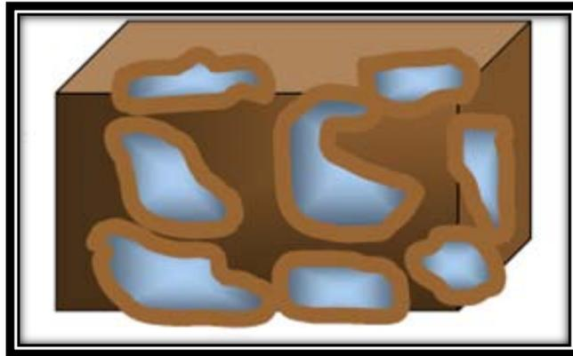
Figura 1.4. Saturación de un fluido en los poros de la roca.
