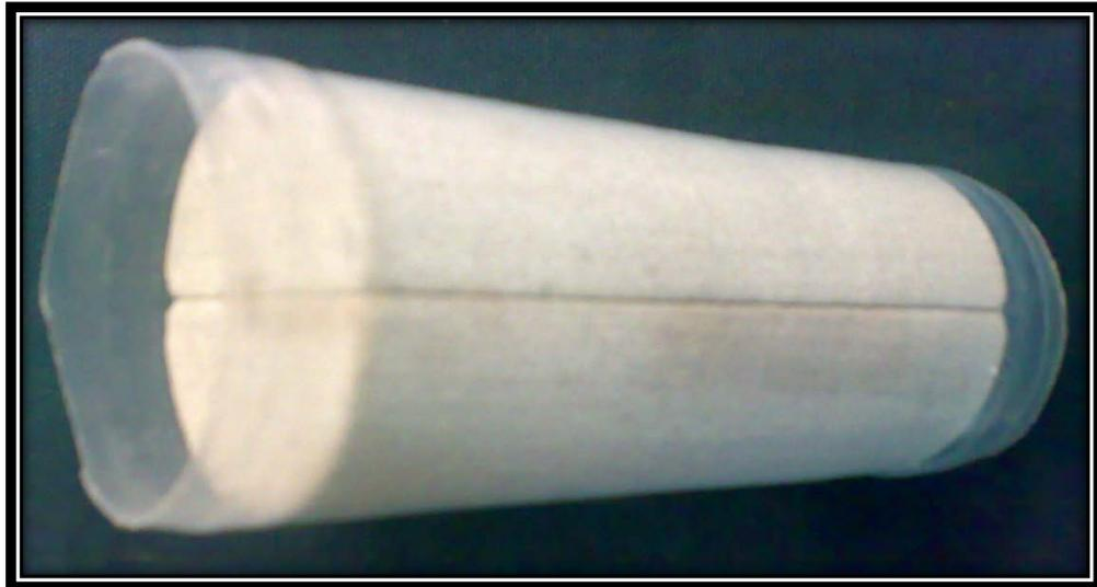
**Figura 4.3. Núcleo enmangado con plástico termoadherible.**
