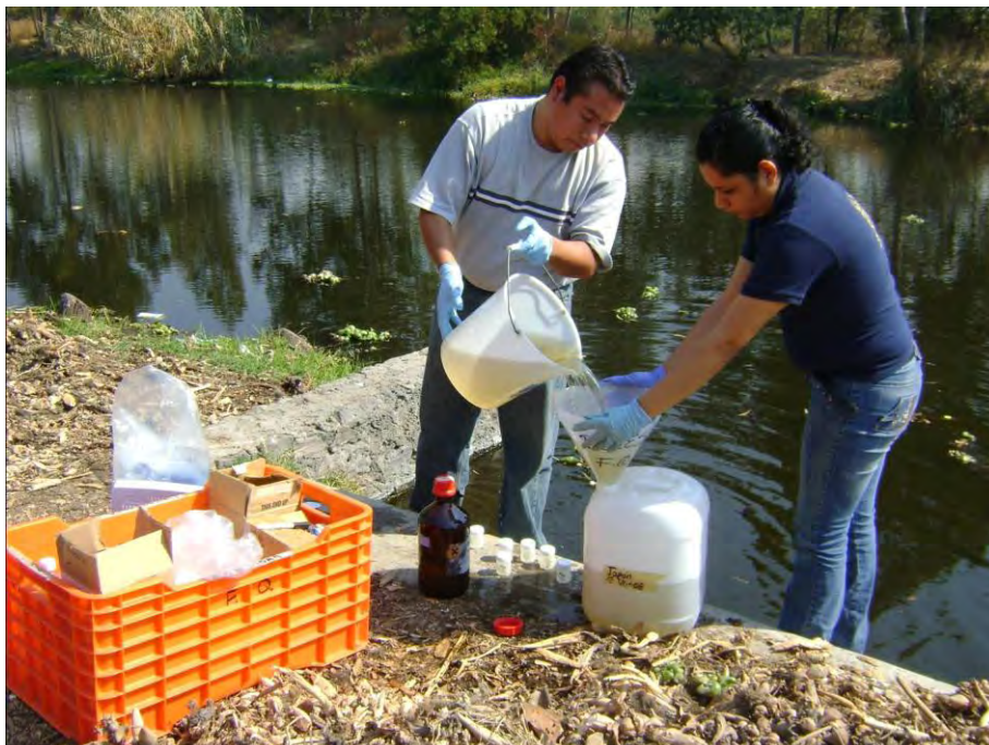
TOMA DE MUESTRAS DE AGUA PARA EL TRATAMIENTO CON EL IÓN FERRATO.
