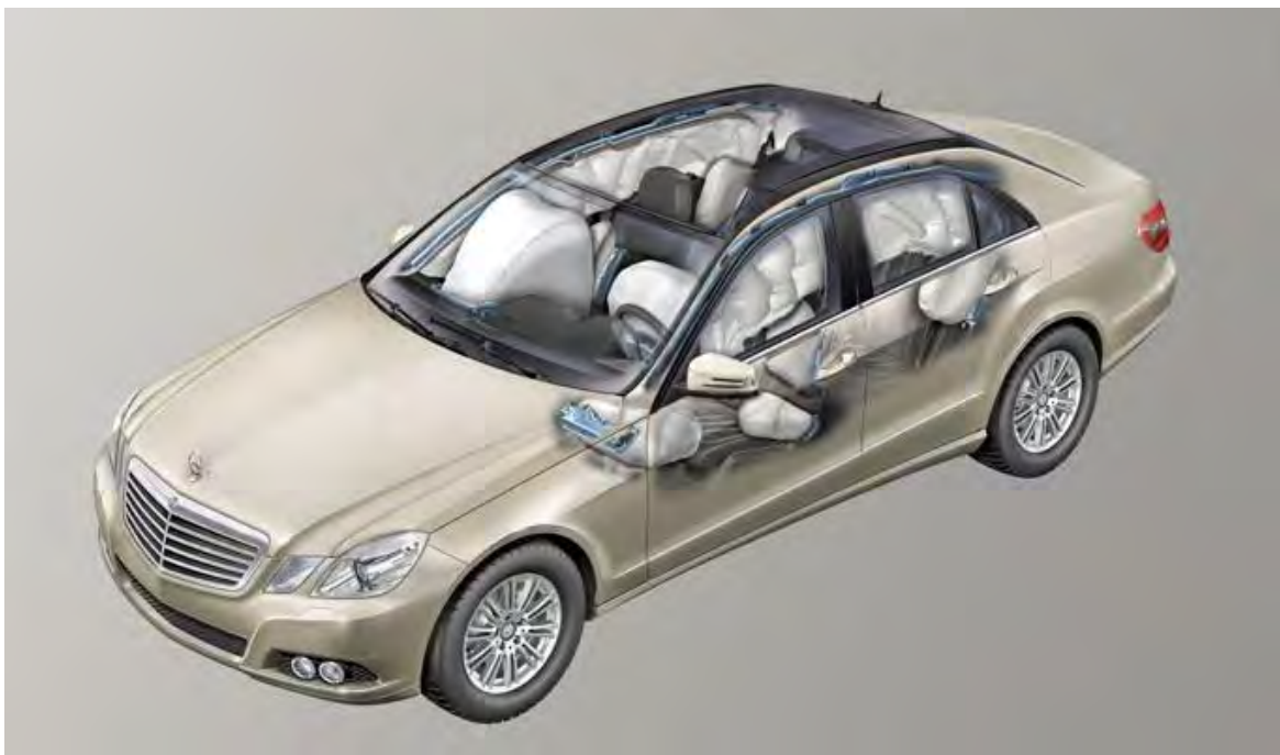
Figura 2.13 – Sistema de 9 bolsas de aire del Mercedes Benz Clase E modelo 2010.
