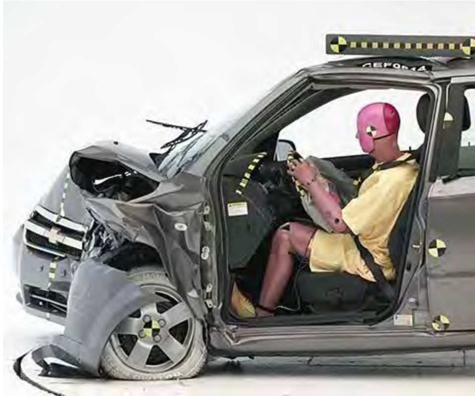
Figura A.2 – La posición del maniquí en relación al volante y el tablero después de la prueba, indica que el espacio de supervivencia se mantuvo razonablemente aceptable.
