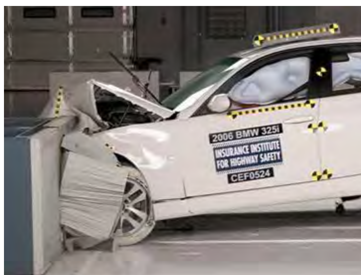
Figura 1.11 – Foto proporcionada por el IIHS (Insurance Institute for Highway Safety). Muestra la prueba de impacto frontal de un BMW 325i modelo 2006.
