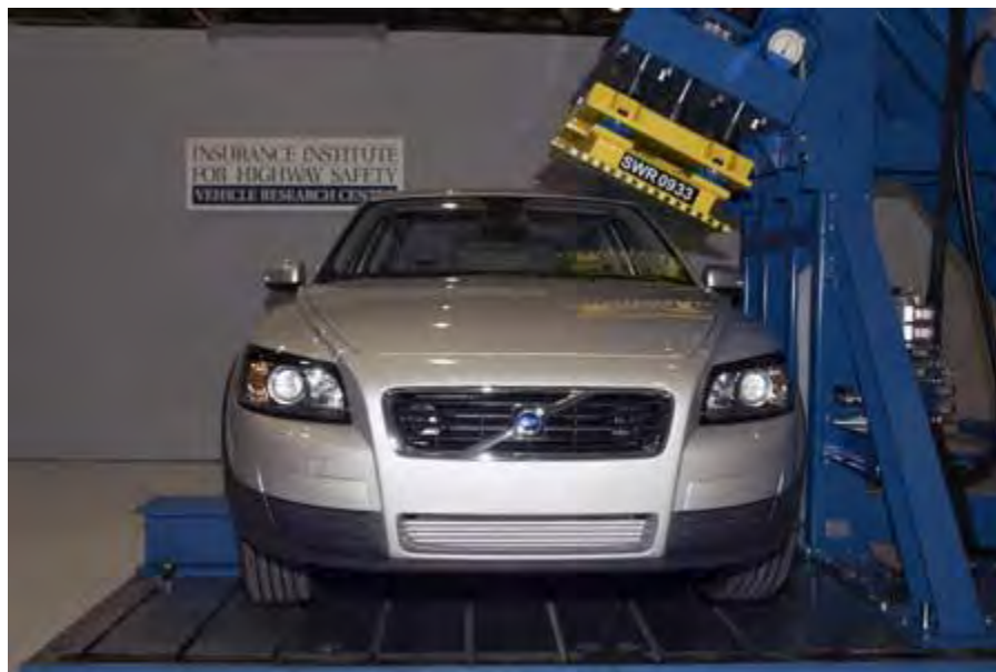
Figura 2.4 – Prueba de resistencia al toldo realizada por el IIHS a un Volvo C30 modelo 2010.
