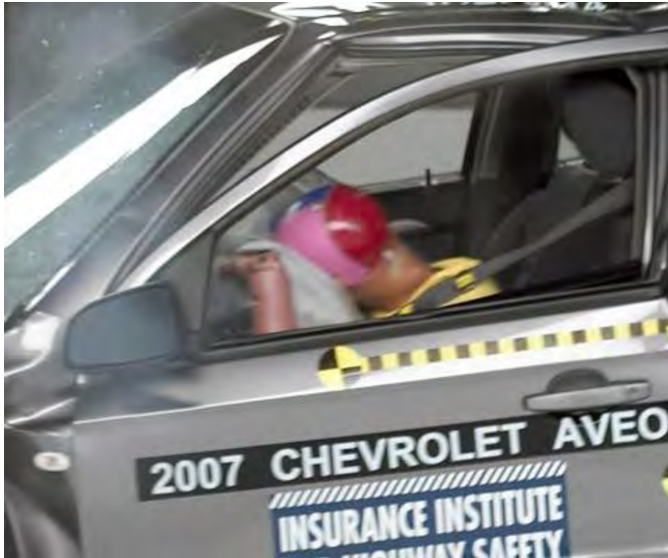
Figura A.3 – La cabeza del maniquí golpeó el volante a través de la bolsa de aire durante la prueba.
