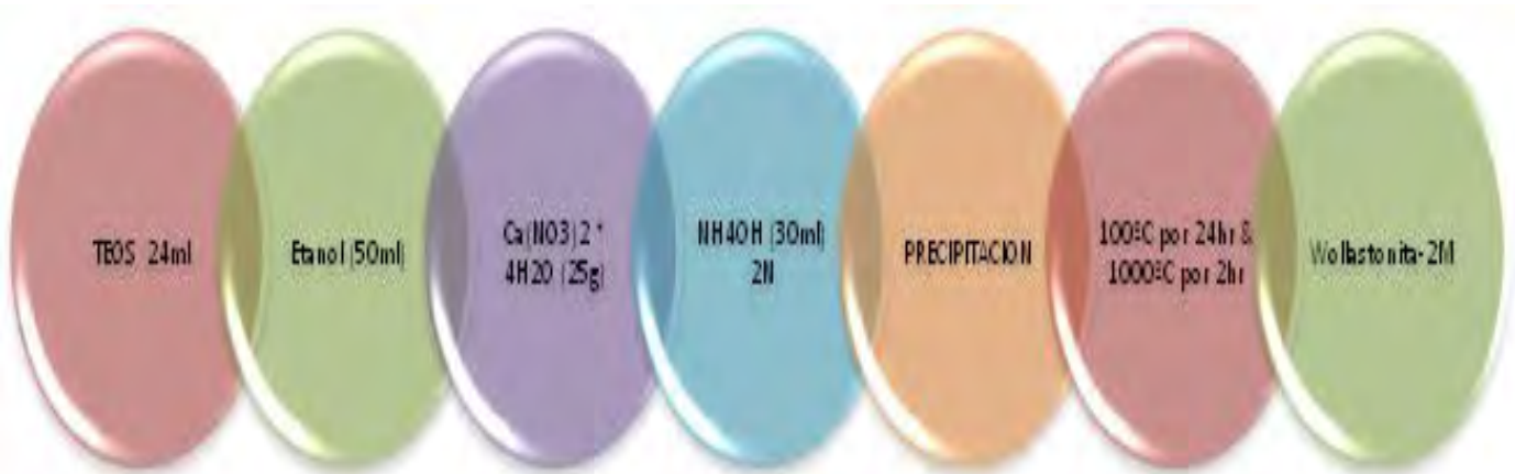
Fig. 10 Diagrama de flujo mostrando las rutas de la síntesis del material: Wollastonita-2M
