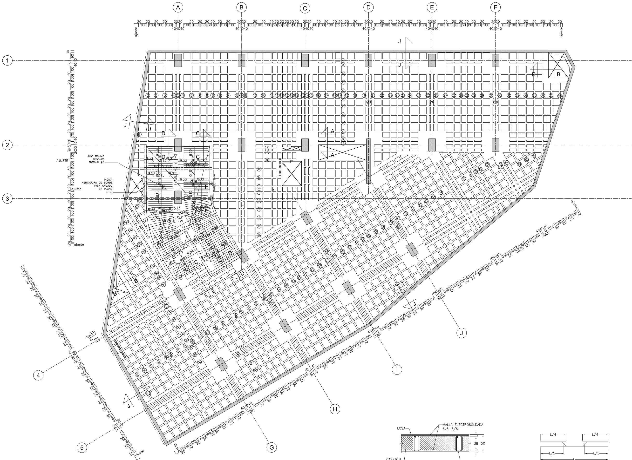
DETALLE DE LOSA RETICULAR (h=50cm)
