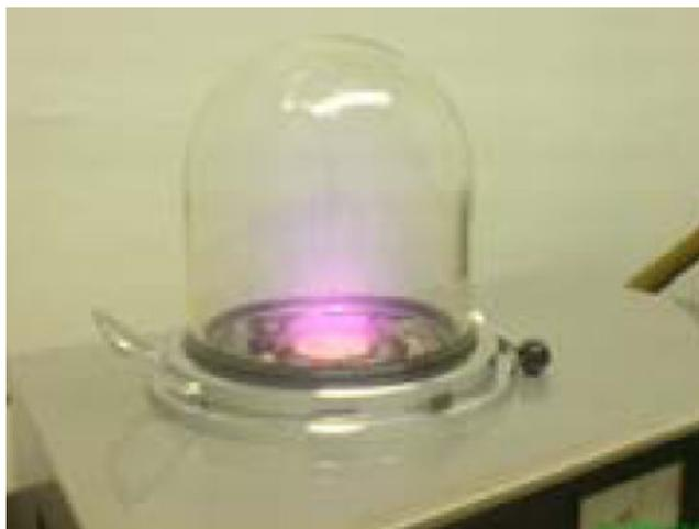
Figura 3.6. Equipo para recubrimiento con Au.
