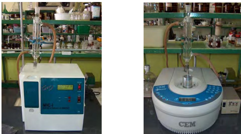
Figura 3. Hornos de microondas químico monomodal.
