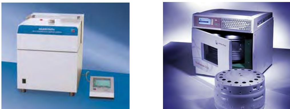
Figura 4. Hornos de microondas químico multimodales.
